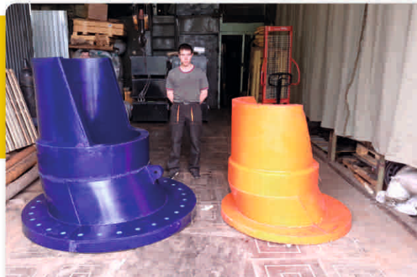
Насадки желоба для подачи сырья в шаровую мельницу
