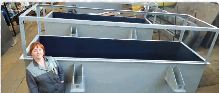
Жёлоб песковый футерованный полиуретаном
