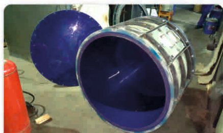
Футеровка шаровой мельницы полиуретаном
