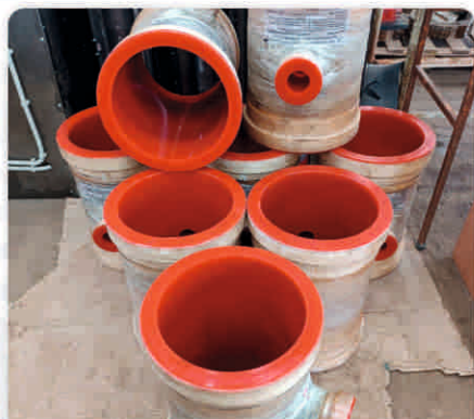
Тройники, отводы, трубы, футерованные полиуретаном
