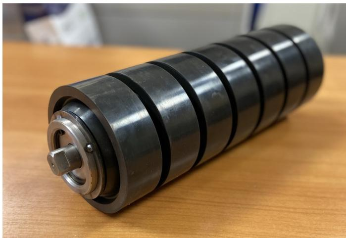
Ролик гуммированный для «перегрузов»
